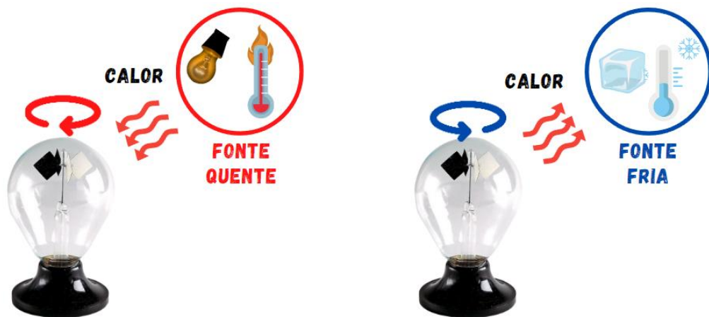
Figura 34 - Sentido de Rotação do radiômetro com a mudança de uma fonte quente para uma fria.
